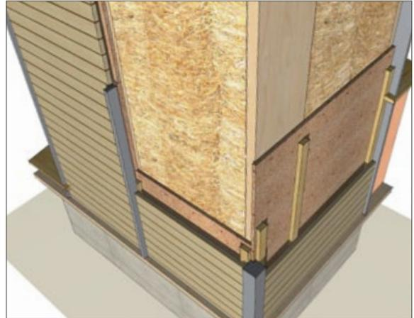
3D-Bild Hausecke einer verschalten, plattenbekleideten Außenwand
