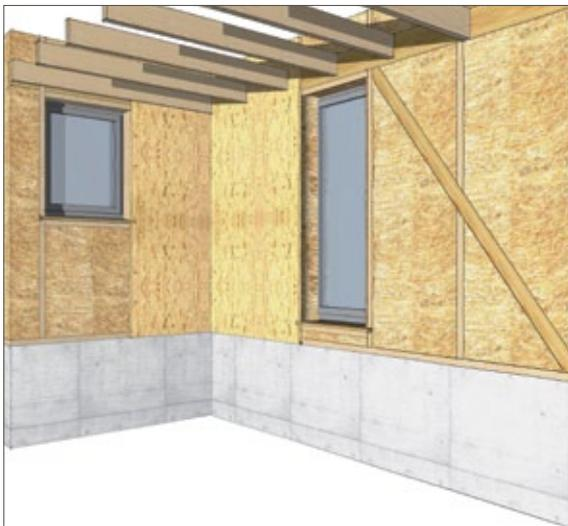
Innere Bekleidung/Aussteifungsmöglichkeiten: links Holzwerkstoffplatte (z. B. 3-Schichtplatte), rechts Holzstrebe
