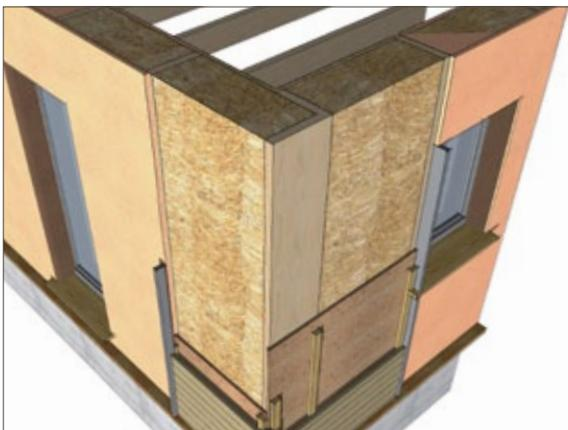
*Ausfachende Konstruktion – direkt verputzt und plattenverkleidet*
