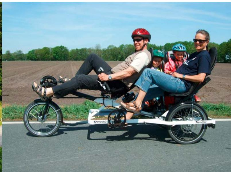
Das Liegerad punktet durch den niedrigeren Luftwiderstand, im Bild mit zwei Treteinrichtungen.
